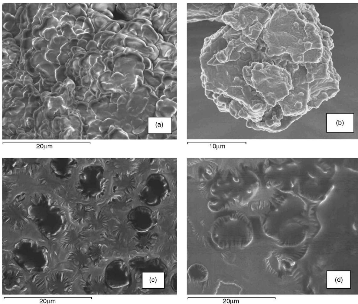
Fig. 1. Scanning electron micrographs (3000 $\times$ ) of molten Gelucire<sup>®</sup> 44/14 (a), cryogenic grinded Gelucire<sup>®</sup> 44/14 (b), molten Gelucire<sup>®</sup> 44/14/ketoprofen mixture (c) and cryogenic grinded Gelucire<sup>®</sup> 44/14/ketoprofen mixture (d).
