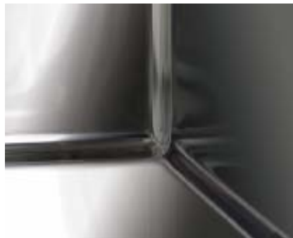
图 9 不锈钢抛光内壁 圆角设计
