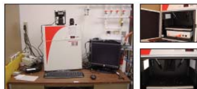
图 1. Alpha Innotech 公司的 FluorChem® 9900 成像系统采用-10°C冷却的黑白 CCD 照相机在暗箱内成像(右侧)
