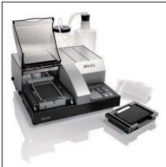
真空抽滤模块可自动化清洗滤板，并可以根据滤板底部的孔径和样品粘滞度调整不同真空抽吸力。
