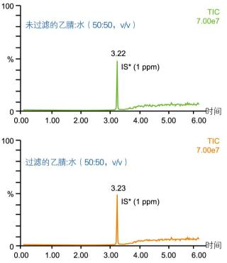
**检测** - **质谱**: ES+模式; **质谱范围**: 100.00-1400.0 色谱柱: Waters Acquityu UPLC BEH 1.7 µm - 2.1 x 50 mm 流动相A: 甲醇(含有0.1%甲酸) 流动相B: 水(含有0.01%甲酸) 进样模式: 梯度 - 6分钟
