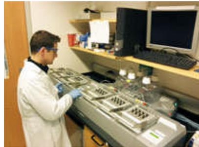
Francisco 博士研究团队的具体手法包括，1) 将感兴趣的目标蛋白；多肽或者是脂质构建成相应的微阵列；2) 采集各种多发性硬化症病人或者是相应疾病模型动物的样本；3) 将采集的样本与构建的微阵列进行杂交；4) 通过解析杂交芯片结果，发现或确定潜在的疾病相关物质（Biomarker）。整个过程中涉及到微阵列的构建、杂交、结果阅读（扫描）、以及结果解析/数据处理。Tecan 的分子杂交工作套餐，包括 HS Pro 4800™ 杂交仪以及高分辨率激光扫描仪 PowerScanner™ 分别承担了全自动样本杂交以及芯片阅读的工作。PowerScanner 扫描仪产生的海量数据通过 Tecan 的分析软件进行数据处理后即筛选出可能的多发性硬化症发病相关物质 (biomarkers)，并最终解明相应的多发性硬化症病理学机理。研究的终极目的则期望能够对疾病干预过程中应该调控的信号通路进行预测或评估。
