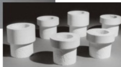
工作管适配器—可以减少热量损失提高温度均一性，每个管式炉配有一套（2个）2英寸的适配器
