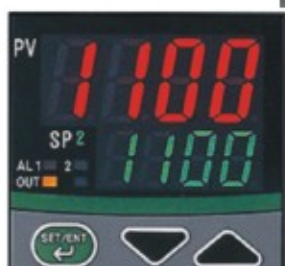
型号STF55346C，三区控温管式炉带3个可编程温度控制器分别控制3个炉区
