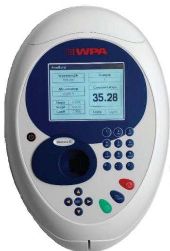
Biowave II 二极管阵列紫外可见分光光度计具有 Lightwave II 的所有功能，同时具备了生命科学的关键应用。它预置了核酸定量（DNA, RNA 和 Oligo）、蛋白检验（BCA, Biuret, Bradford 和 Lowry）和细胞培养密度测量的方法。核酸扫描的可视特别有用，尤其对于 RNA 样品，其纯度体现在 230nm 区域，而对 A260/A280 的比值没有负面影响。该仪器兼容一次性低样品量的紫外可见比色皿。
