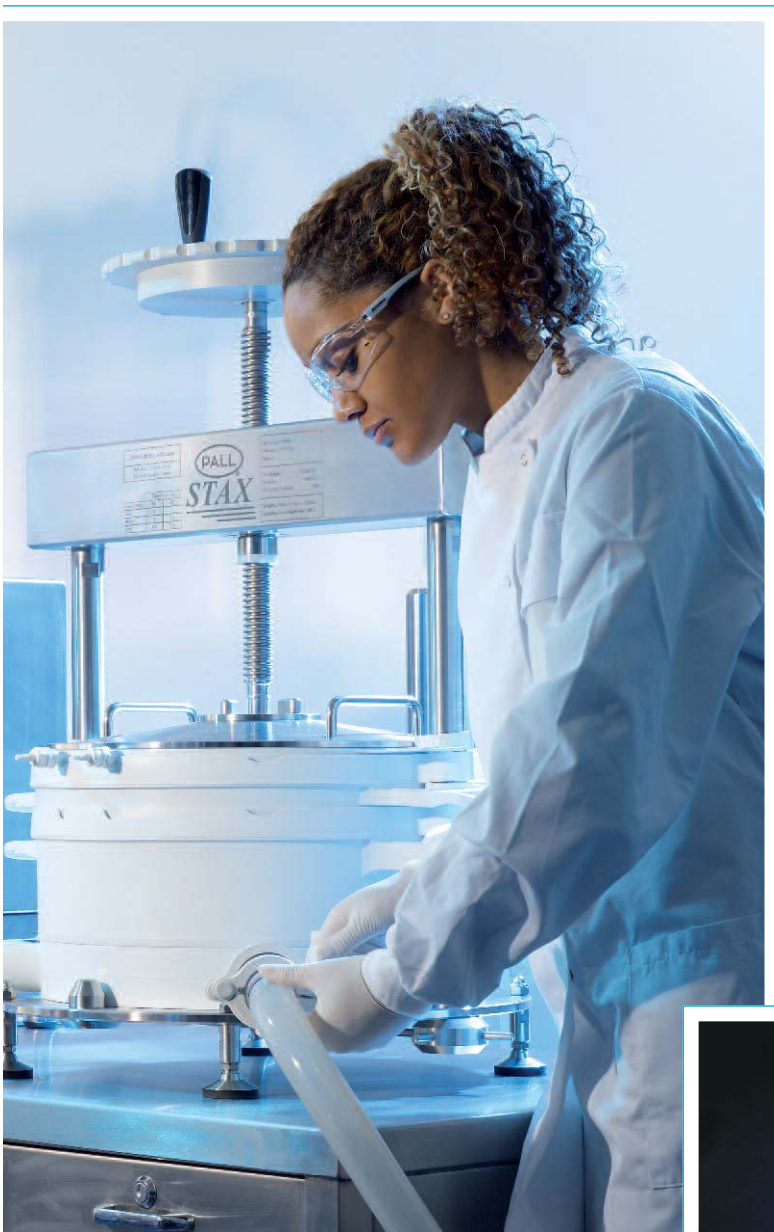
上图: 装载有Stax膜堆的中试底盘 右图: Seitz深层滤板
