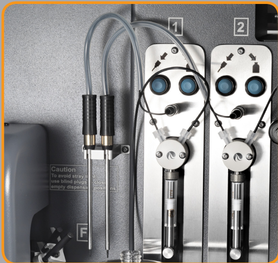
图1 自动分液器，实现快速而精准的同时分液检测
