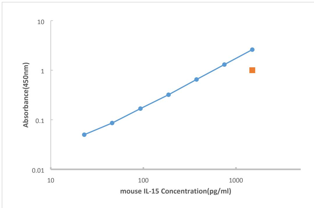
本图仅供参考，应以当次试验标准品绘制的标准曲线计算小鼠 IL-15 的样本含量
