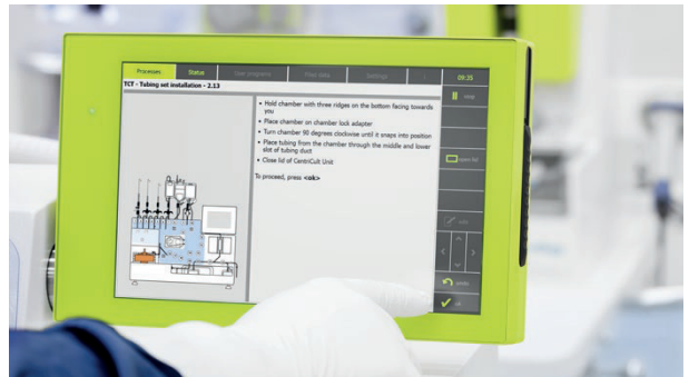
图2：CliniMACS Prodigy管路的安装由用户界面引导。
