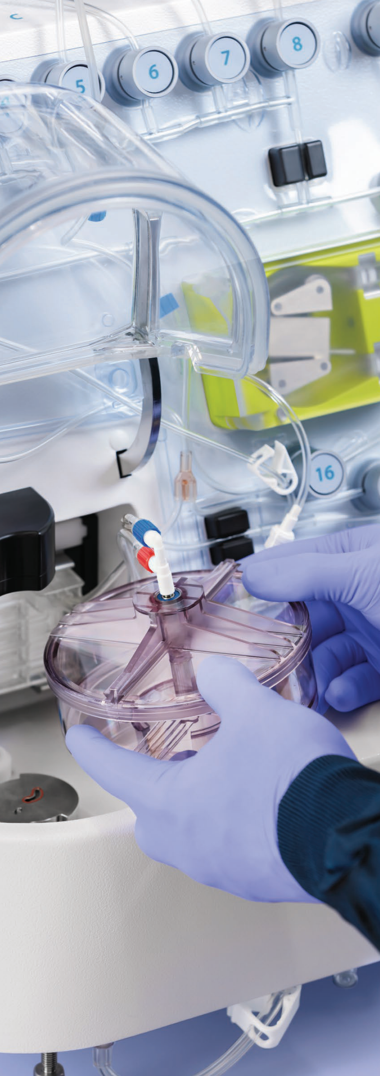
图2：CliniMACS Prodigy管路的安装由用户界面引导。
