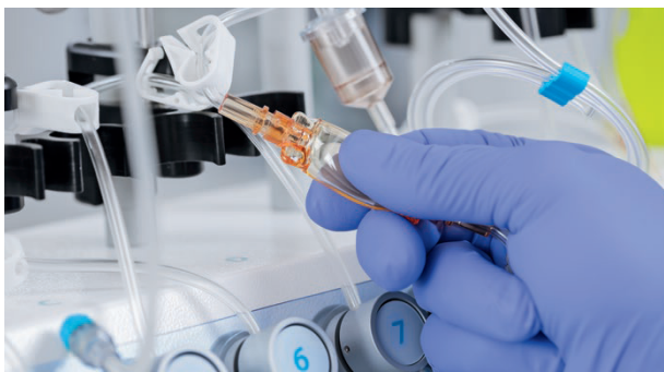
图4: 取样小袋实现在细胞制备工作流程中轻松的进行无菌取样。
